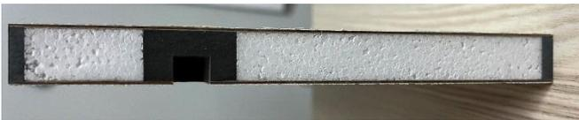
Alle Kanten sind mit Polyurethane (PU) Kunststoff vergossen und somit absolut wasserdicht. Zudem wurden an all denjenigen Stellen PU-Blöcke / Einleger integriert, wo geschraubt werden muss bzw. wo das Möbelteil spezielle Anforderungen an Stabilität benötigt.
