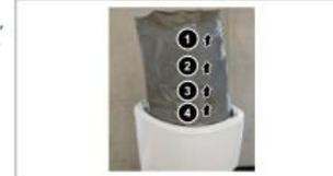
8. Klappen Sie die Folie nach innen und verteilen Sie sie gleichmäßig im Folienraum.
