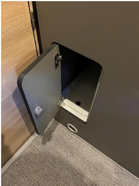
Der Fäkalientank kann auf der Fahrerseite von außen über eine entsprechende Service-Klappe erreicht werden und zur Entleerung entnommen werden.
