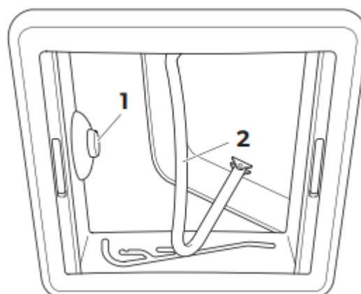
Dachhaube Öffnen: Den Sicherungsknopf (1) drücken und den Bügel (2) mit beiden Händen nach unten ziehen. Den Bügel in den Führungen bis in die hinterste Position ziehen.
