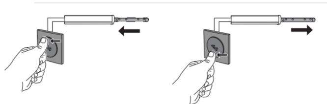
**Ausfahren:** Wippschalter nach unten drücken, bis die Trittstufe vollständig ausgefahren ist.
