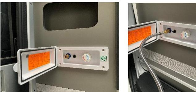
System bis Anfang 2025: Bei Betätigung des mittleren Kipp-Schalters wird die Wasserpumpe aktiv (hörbar durch Anspringen der Pumpe im Wassertank) und Sie
