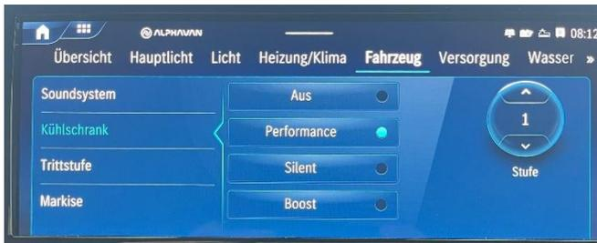
um 180°, weil ansonsten die Markise mit der Heck-Drehtür kollidieren würde. Hinweis: Sollte die Funktion zum Ausfahren der Markise auf dem Display inaktiv / ausgegraut sein, so muss kurz der Start-Knopf des Fahrzeugs gedrückt werden, um durch Aufwecken der Fahrzeug-Bus-Systeme die Funktion wieder zu aktivieren.
