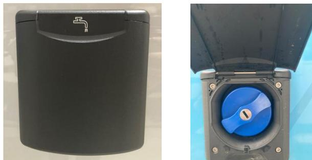
Wir empfehlen, dass Sie den Tank für den Betrieb im Stand bis maximal 85% füllen und nie ganz randvoll füllen, um versiegelte Zugänge / Öffnungen nicht zu belasten und im schlimmsten Fall Eindringen von Wasser zu vermeiden.
